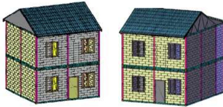
Gambar 2. Skematik rumah modular pracetak bertingkat.
