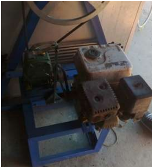
Gambar 6. Mesin Pemutar dan Reduction Gear
