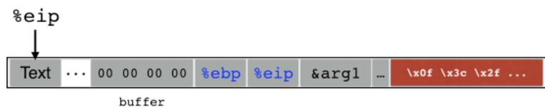
Gambar 2.15 Contoh Menjalankan Kode untuk Disuntikkan
