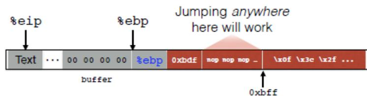
Gambar 2.17 Contoh Nop Sleds pada Stack
